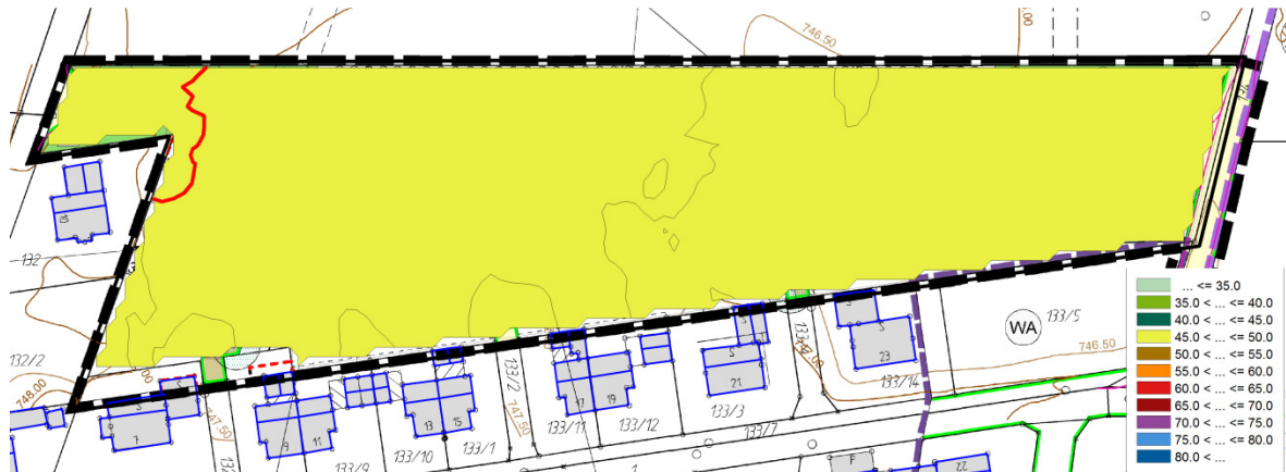
Abb. 7: Rasterlärmkarte nachts, rot Markiert die 48 dB(A) Isophone in 4,00 m Höhe gem. 34.BlmSchV
