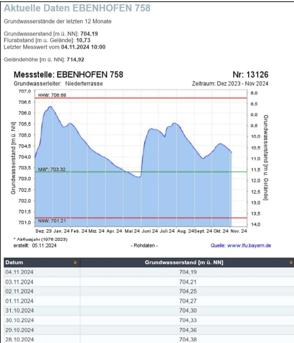
Überträgt man den Aufschlag von 2,32 m auf die im Baugebiet gemessenen Wasserstände so ergeben sich für den Höchstwasserstand HHW im Baugebiet - in Abhängigkeit vom festgestellten Grundwasserspiegelgefälle - folgende **Bemessungswerte** (Höchstwasserstände zur Bemessung von Auftriebssicherungen und Abdichtungen):
