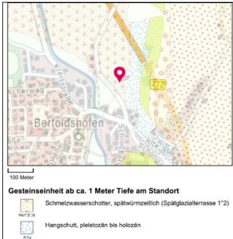
Der **Schmelzwasserkies** besteht aus einem sandigen, teils steinigen, teils schluffigen und in Lagen partiell stark schluffigen Kies (weit gestuftes Rundkorn). Die Lagerungs-dichte ist mitteldicht bis dicht.
