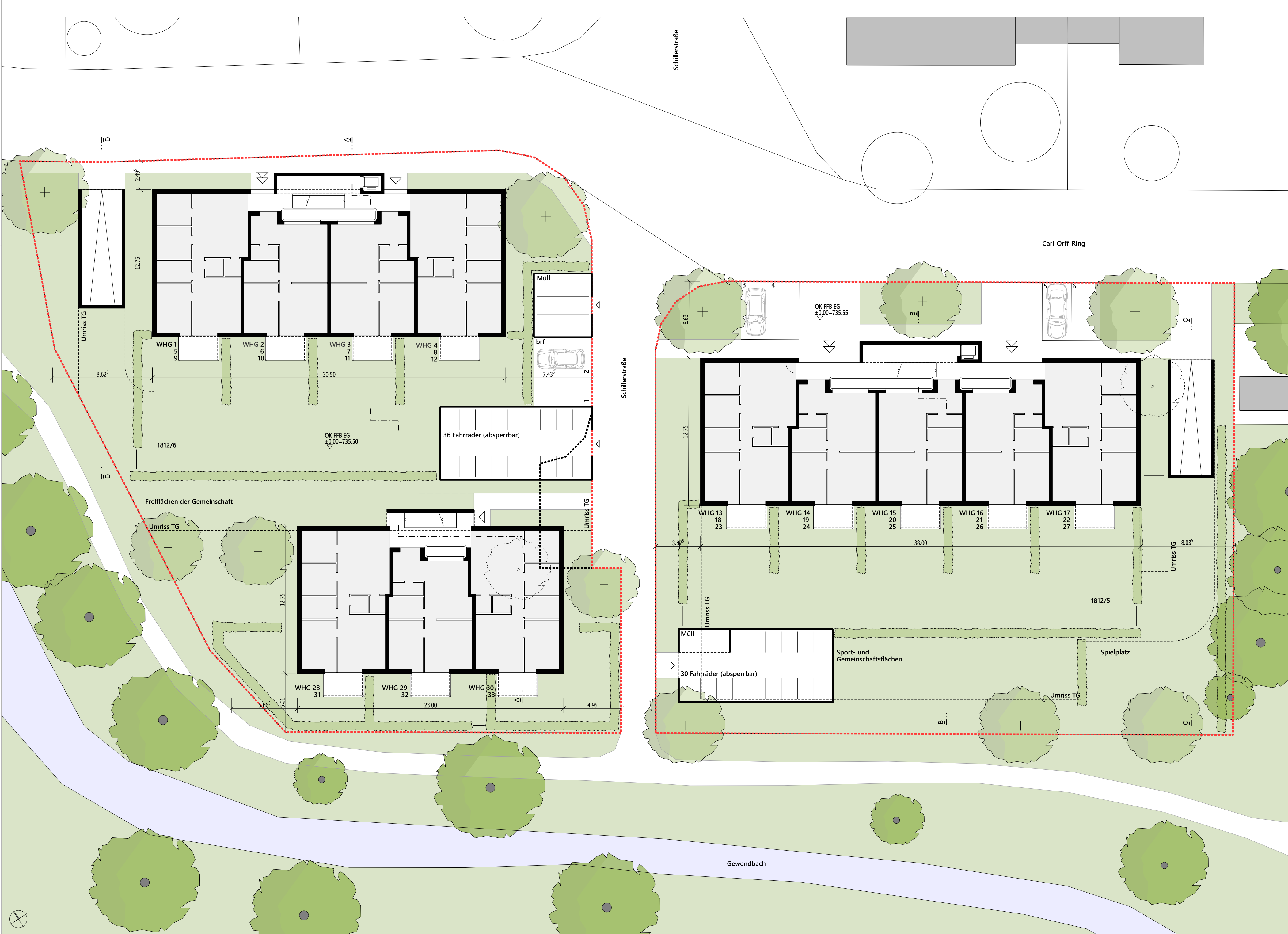
GRUNDRISS EG (OG1 und OG2 entsprechend EG)
